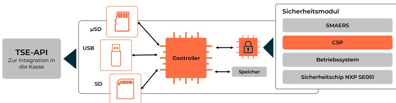
Die cryptovision TSE v2.1 basiert auf einer µSD-Karte mit Schnittstellen zu einer PC- oder Smartphone-Software. Sie ermöglicht den standardisierten Export von Daten im Rahmen von Außenprüfungen und Kassen-Nachschauf der Finanzbehörden. Die SD- und die USB-Schnittstelle werden über Adapter unterstützt.
